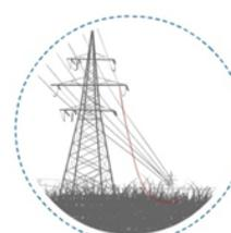
Безопасное расстояние - 8-10 м от места контакта электрического провода с землей (полюсом).
